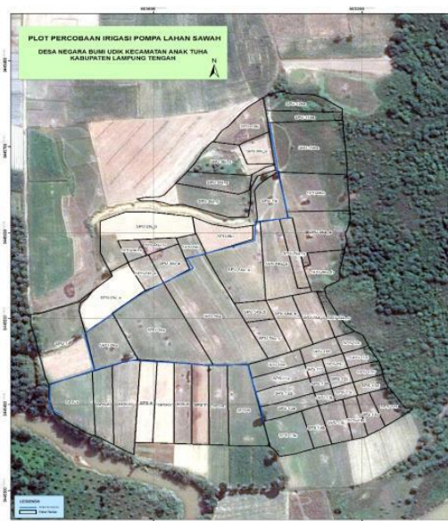
Gambar 20. Hasil pemetaan lokasi demfarm seluas \pm 9,2 ha dan desain irigasi di Desa Bumi Udik, Kec. Anak Tuha, Kab. Lampung Tengah, Prov. Lampung
