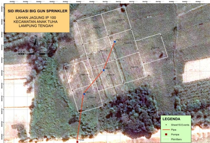
Gambar 3. Instalasi Sistem Irigasi Big Gun Sprinkler untuk tanaman Jagung di Desa Bumi Udik, Kec. Anak Tuha, Kab. Lampung Tengah
